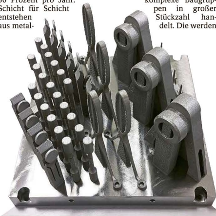
Musterbauteile mit Stützstrukturen werden vollautomatisch bearbeitet. Foto: Loll
